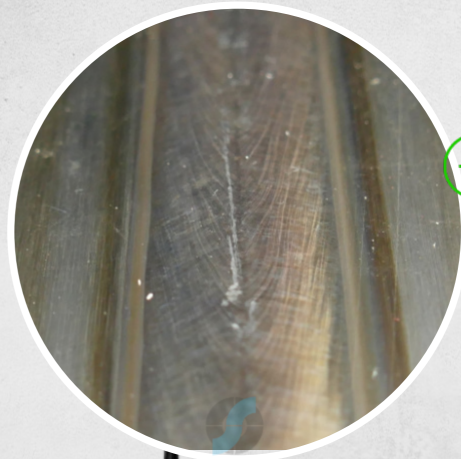
스테인리스 스틸 탱크 두께: 10mm 플라스마 키홀
