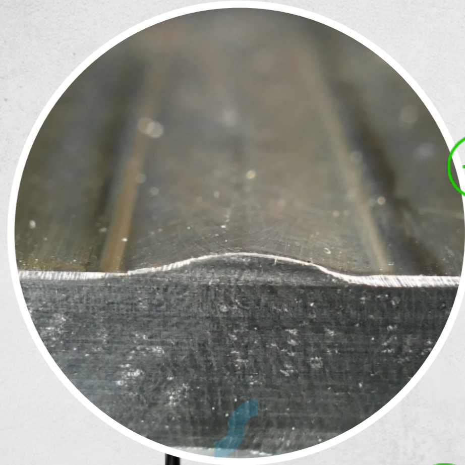
스테인리스 스틸 탱크 두께: 10.0mm 플라스마 키홀
